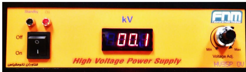
شکل ۴-۱۸- منبع تامین ولتاژ بالای نصب شده بر روی دستگاه الکتروریس (مدل HV35P OV).
