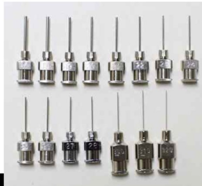
شکل ۱-۴- انواع نازلها با قطرهای داخلی مختلف قابل استفاده در دستگاه الکتروریس.
